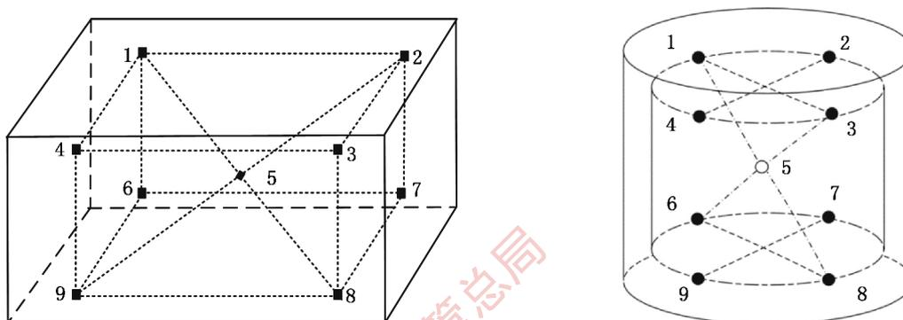
图 2 工作空间深度大于 15 cm 时的温度测量点分布示意图
